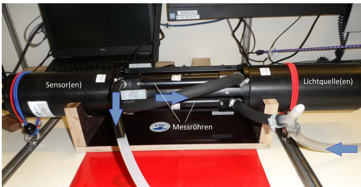
Abbildung 1 Das eingebaute "AC-S".
